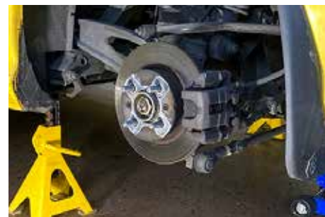
Här är oket på plats igen. Ta hjälp av en kompis med att provbromsa med både fot- och handbroms så att du kan kontrollera att bromsarna låser ordentligt. Passa även på att göra rent och smörja upp de rörliga delarna till handbromsen. Klart att sätta på hjulet och släppa ner bilen. Glöm inte att kolla bromsvätskenivån och sätta på locket på behållaren.
