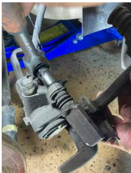
Här är fästbygeln monterad och beläggen med sina bleck ditsatta. Det kan vara lämpligt att slipa av ytan på beläggen lite lätt med smärgelduk före montering för att få rena ytor mot bromsskivan.
