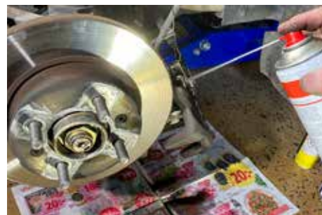
Bromsdelarna görs rena med bromsrengöringsspray (Brake cleaner). Spraya rikligt i flera omgångar, torka av och låt torka.
