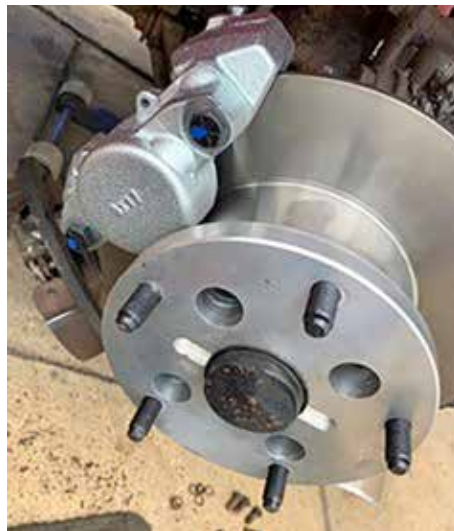
10 Montering av bromsok och nav är klart.
