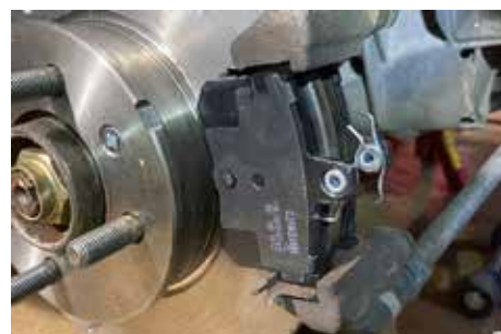
Här är fästbygeln monterad och beläggen med sina bleck ditsatta. Det kan vara lämpligt att slipa av ytan på beläggen lite lätt med smärgelduk före montering för att få rena ytor mot bromsskivan.
