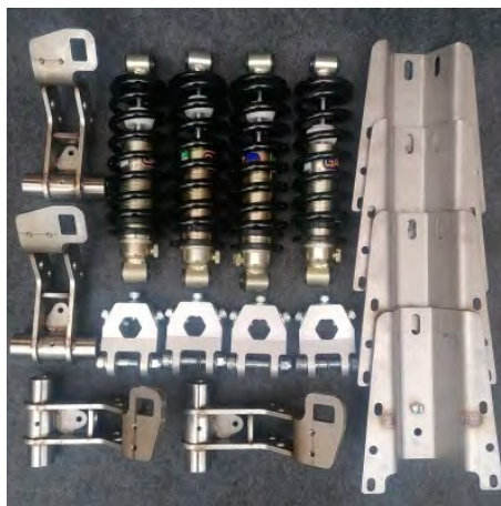
Foto 3 t.v.: FCCKit forophæng Foto 4 t.h.: Pins og monteringsplader (i rustfrit stål) til MGF/TF Bremser foto 4
