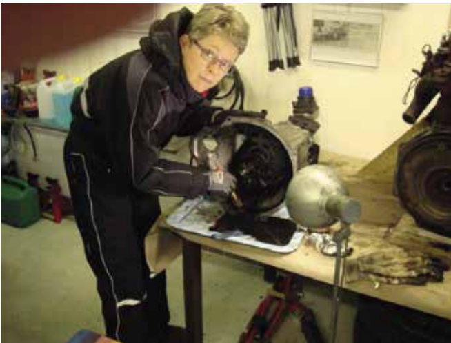
Rengøring af koblingshuset indvendig: Alt på gamle engelske biler er "sovset" ind i olie, desværre for Rikke!
