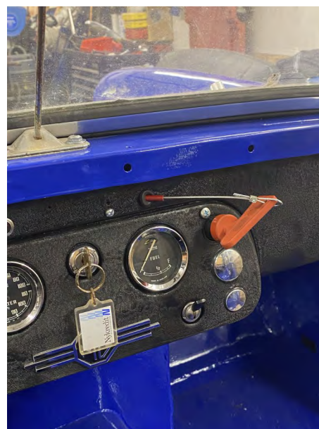
Herunder: Der er lavet hoved afbryder både indvendig og udvendig, den afbryder både batteri og tænding
