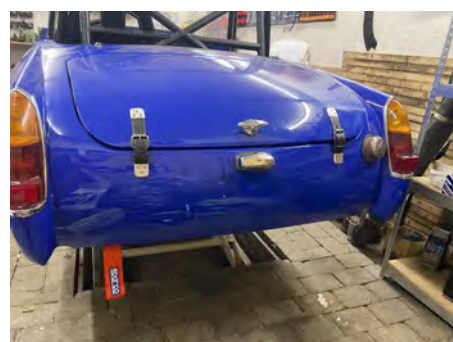
T.v. herover: Karburator er en dobbelt 45mm Weber som er blevet rensset og justeret T.h. herover: Bagklap er fastgjort med extra remme
