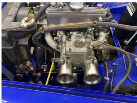
T.v. herover: Karburator er en dobbelt 45mm Weber som er blevet rensset og justeret T.h. herover: Bagklap er fastgjort med extra remme
