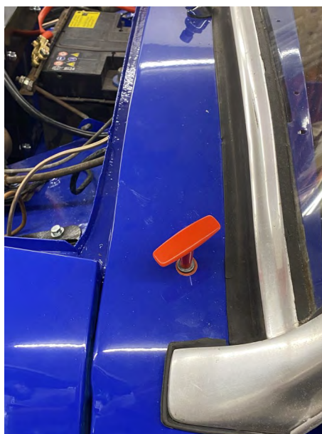
Herunder: Der er lavet hoved afbryder både indvendig og udvendig, den afbryder både batteri og tænding
