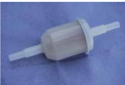
Billigt, men effektivt benzinfiler. Filtret skal monteres så benzinen løber samme vej som pilen på filtret angiver.
