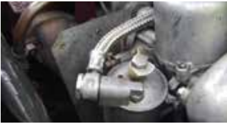
Svømmerhuset på en MGA-karburator (SU H2/H4). Omtalte benzinslange og banjobolt fotograferet på det forreste svømmerhus.
