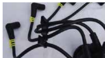
Sådan ser en blæksprutte ud! Men det er ikke en ægte blæksprutte, men et strømfordelerdæksel med tænd kabler, der er afmærket med ledningstrips.
