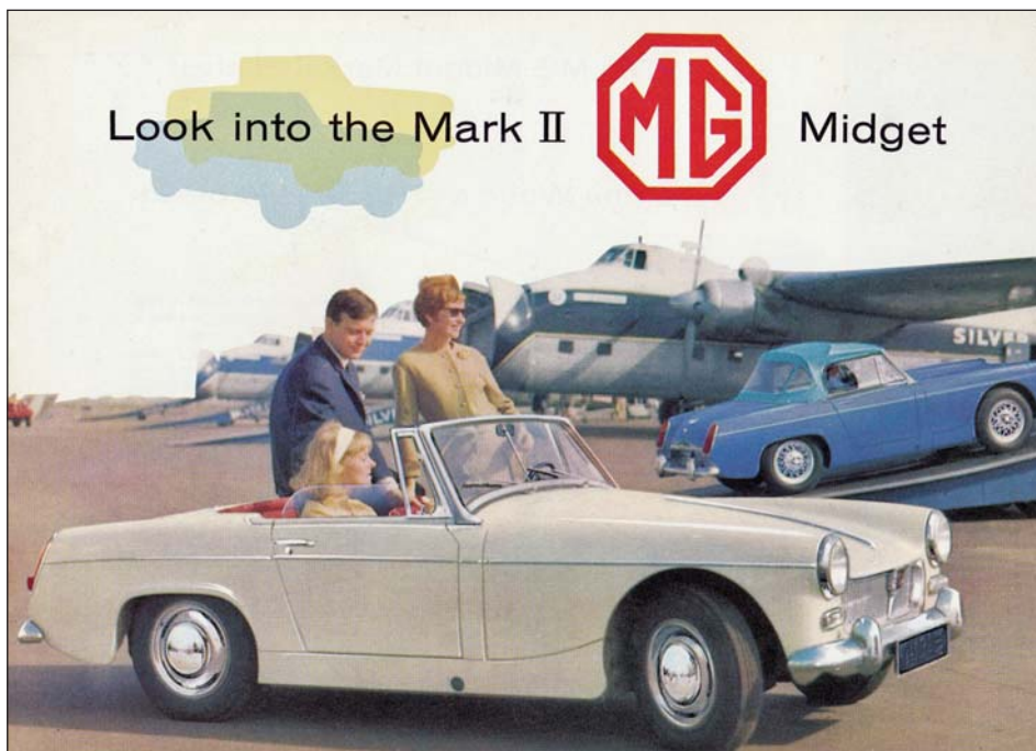
Midget Mk 2. Ny frontrute, sveiveruter og dørhåndtak, nytt interiør og bakhjulsoppheng.
