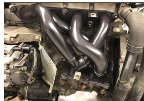
Grenrøret belagt med ceramic coating for mindre varme i motorrommet.
