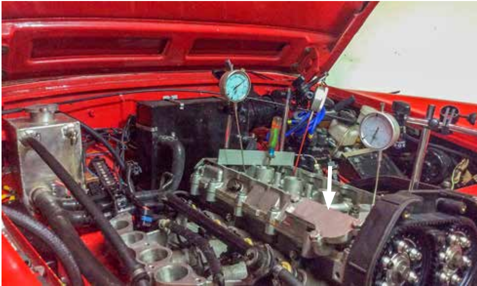
Timing av kamaxlarna. Täcklocket där VVC-enheten satt syns vid pilen.
