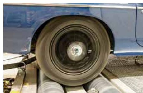
Effekten mäts på rullar likt de som provar bromsarna på bilprovningen.
