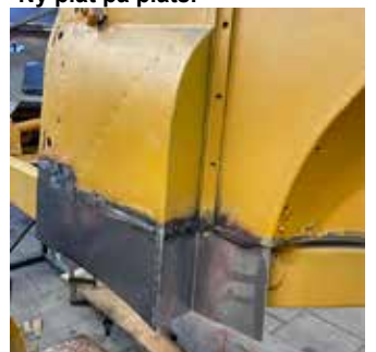
Tröskellådor och plåt från leverans nummer två från England på plats. Nytt fäste bakom ny plåt.
