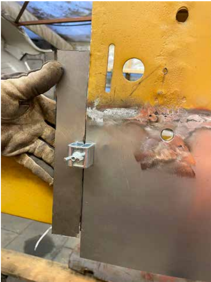
Verktyg som används för att kunna svetsa kant-i-kant.
