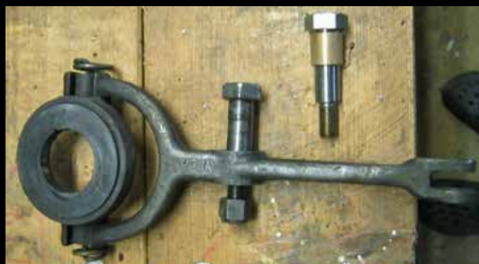
Kopplingsarmen med den nya bulten och bussningen redo för montering.
