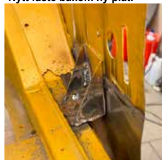
Tröskellådor och plåt från leverans nummer två från England på plats. Nytt fäste bakom ny plåt.
