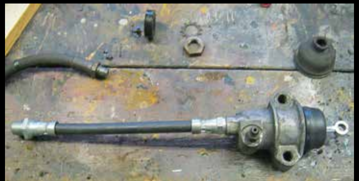
Slavcylinder med nya packningar och slang.
