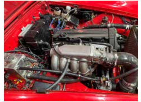
Motorn från insugssidan. Positionen på spjällhuset har flyttats till att riktas framåt för bättre utrymme för insugsfilter. Till vänster expansionskärlet.
