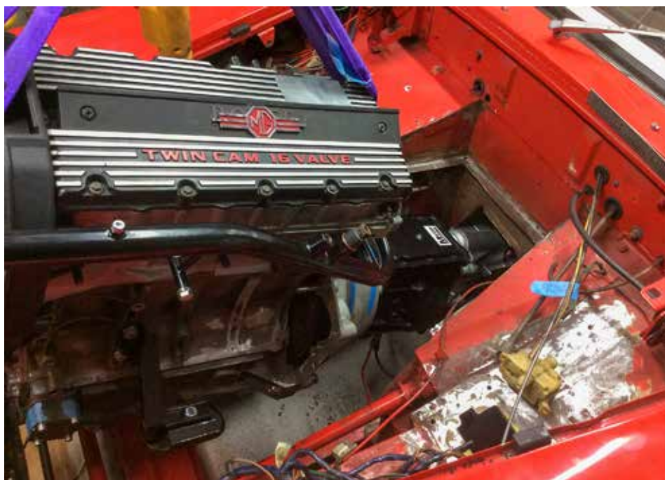
Provmontering av motorn.
