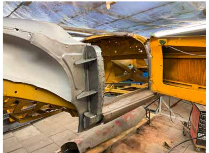
Tröskellådor och plåt från leverans nummer två från England på plats. Nytt fäste bakom ny plåt.
