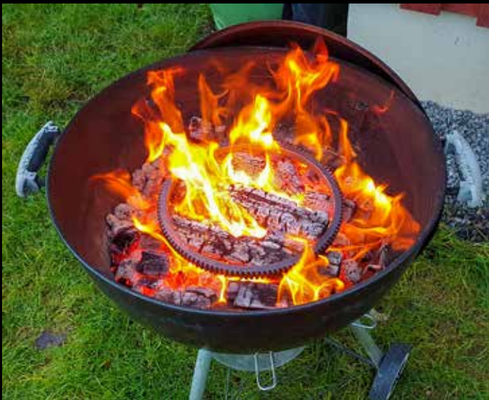
Värmning av kuggkrans på finaste träkol.
