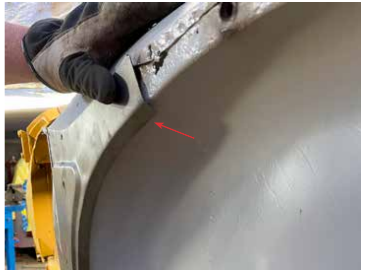
Här går plåten över kanten med en centimeter...
