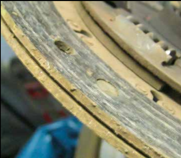
Kopplingen var rejält sliten (2 mm tunnare än den nya) nästan nersliten till nitarna.
