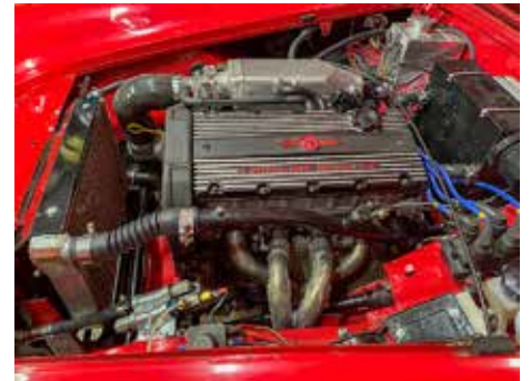
Från utblåssidan. Grenröret köpte Sören från England. Kylaren är av aluminium och har en elfläkt på framsidan.
