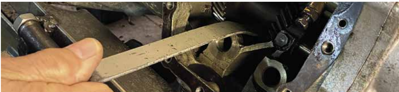
Svend Aage har selv lavet denne bundhjulsløfter til gearkasser
