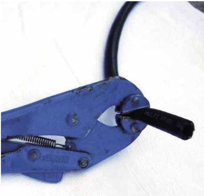
Svejsetangen kan 'uden hænder' holde benzinslangen fastklemmt.
