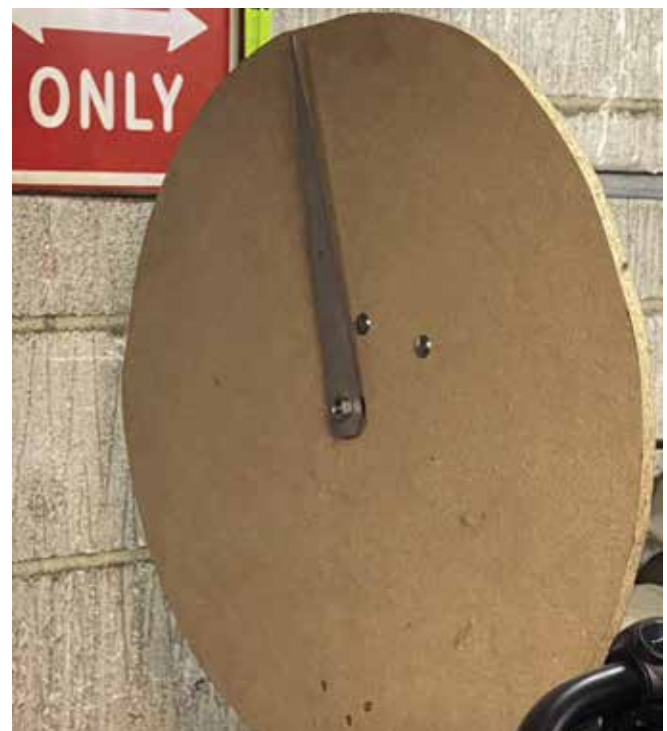
Ringen skal føres hen ad metalstangen uden at røre. En ledning gør det muligt at få et udslag på skiven hvis man rammer
