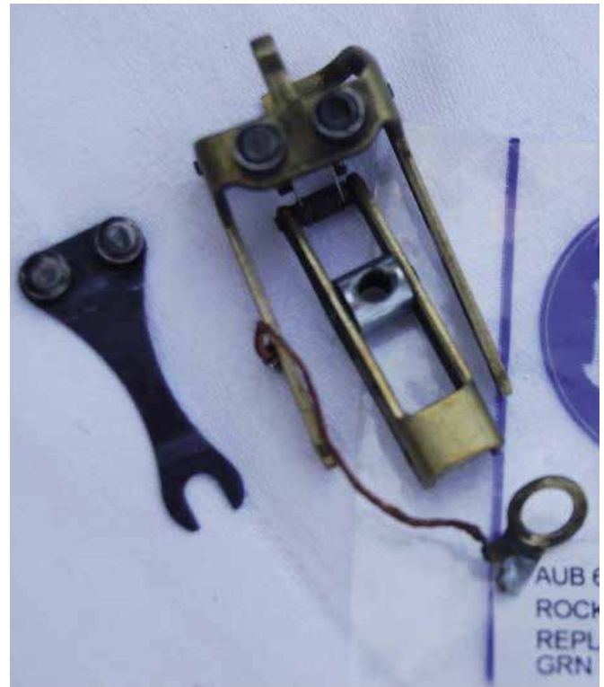
Sådan ser et brugt kontaktsæt ud til en SU benzinpumpe
