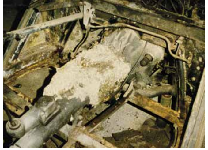
Istandsættelse af MGA - et dyr havde bygget rede i motorrummet
