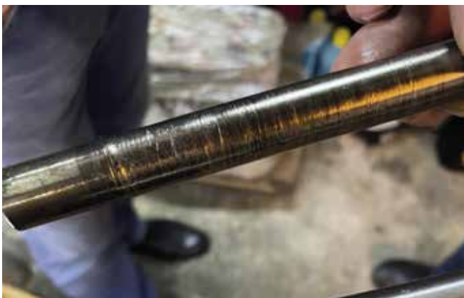
Slidt bundaksel. Bemærk at den er slidt på et langt stykke
