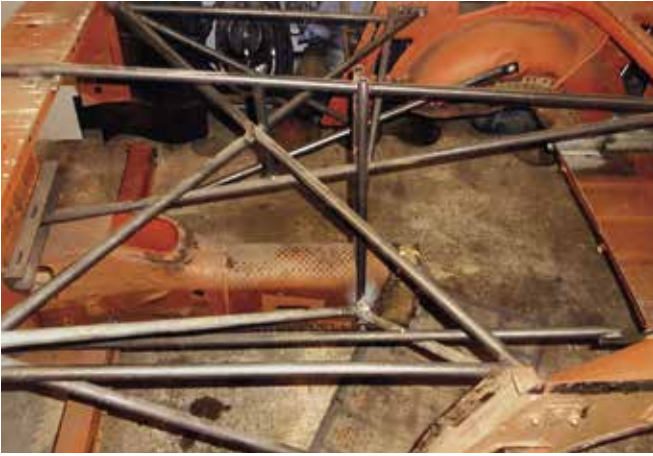
Nærbillede af det stillads Svend Aage havde lavet for at afstive karosseriet
