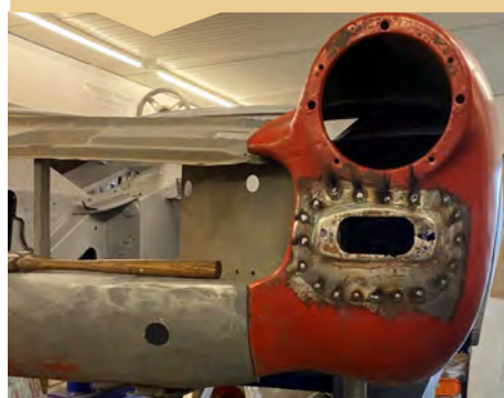
Forskærmene er fra hhv en Mk2 og Mk3 og blinklyset sidder ikke ens. Indfatningen til blinklyset blev flyttet fra den dårlige skærm til den nye
