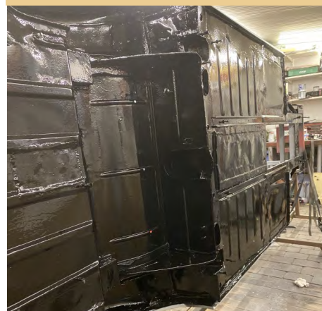
Tilpasning. Bilens pladedele samles for at se om de passer sammen.
