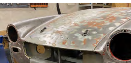
Hjelmlåse er boltet i. Det er et krav ved eksempelvis DASU baneløb, at hjelmen skal være fastspændt, for at undgå at den flyver af ved en evt. kollision.
