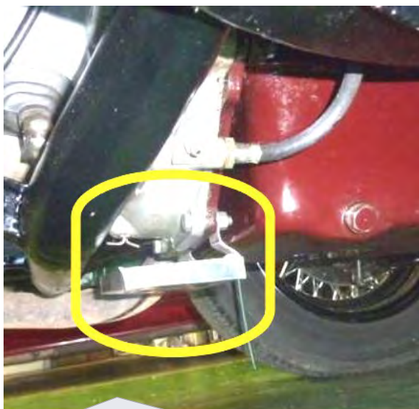
Fig 4 Drypbakke monteret. Desværre fik jeg ikke taget et billede af drypbakken monteret på Magnetten, inden den blev kørt i hi! Derfor må I nøjes med dette foto fra mgaguru.
