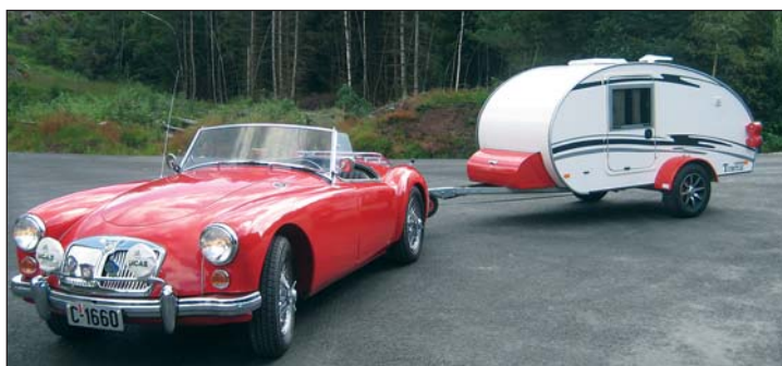
Bjørn Erik Johannesen fant sin campingvogn (Turtle 1200) på e-Bay i UK. dobbeltseng på hjul i 120 cm bredde. Total lengde med drag 390 cm. Vekt 430 kg. Åpen pentry-løsning under lokk bak. Porta Potti. Svært primitiv, men lett å slepe.
