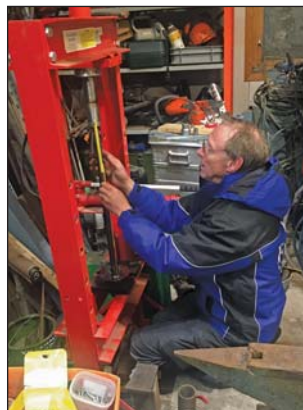
5 tons presse må til for å presse ut bakre aksling på MGBen.
