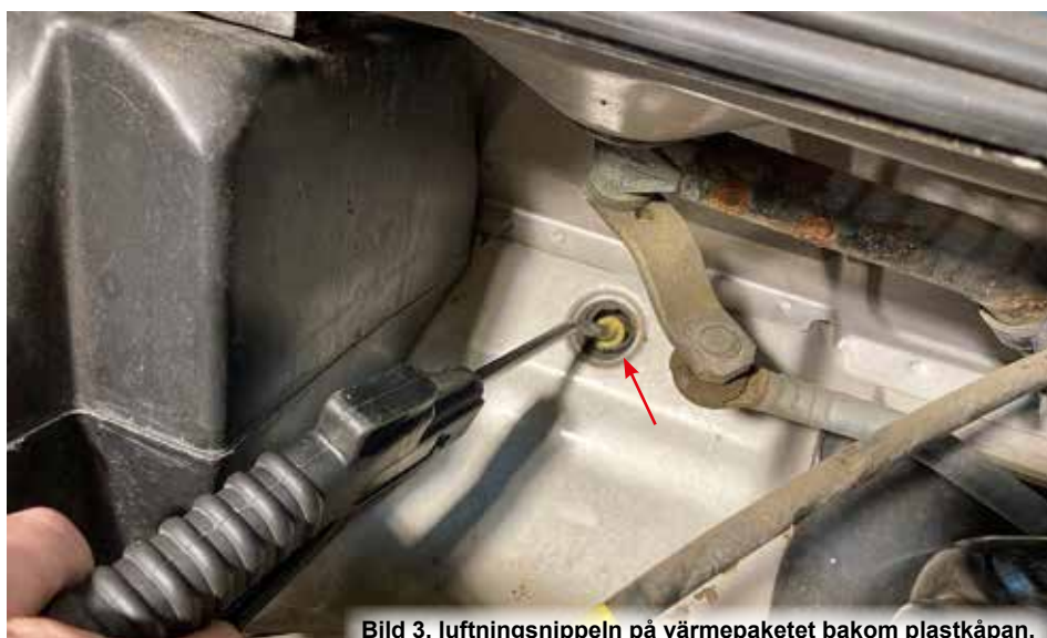
Bild 3, luftningsnippeln på värmepaketet bakom plastkåpan.
