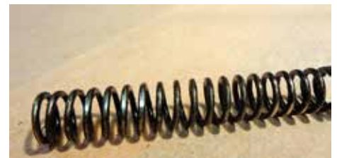
Tryckfjäders i överströmningsventilen.
