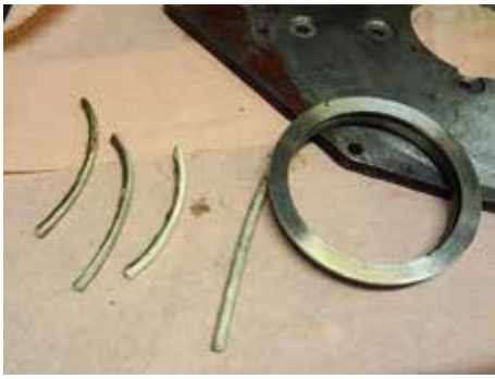
Svarvad ring till filtätning.
