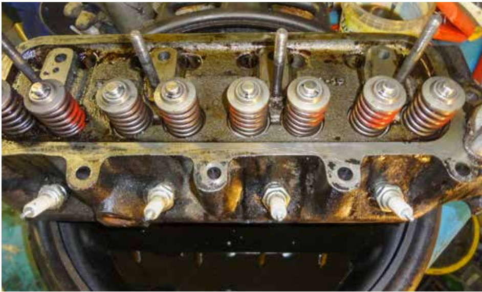
Eftersom cylinderhuvudet tidigare var utbytt var rengöring för att avlägsna PERMATEX det enda som behövdes.
