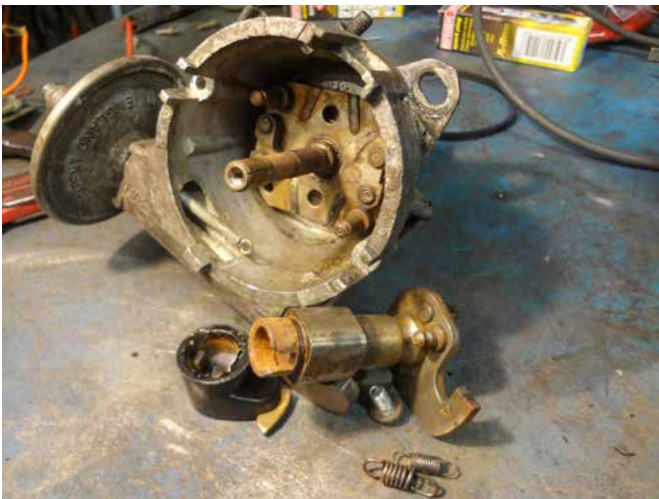
Ibland får man överraskningar, t ex en rostskadad strömfördelare.
