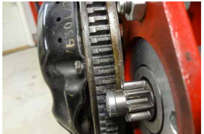
Den nya startmotorn monterad.
