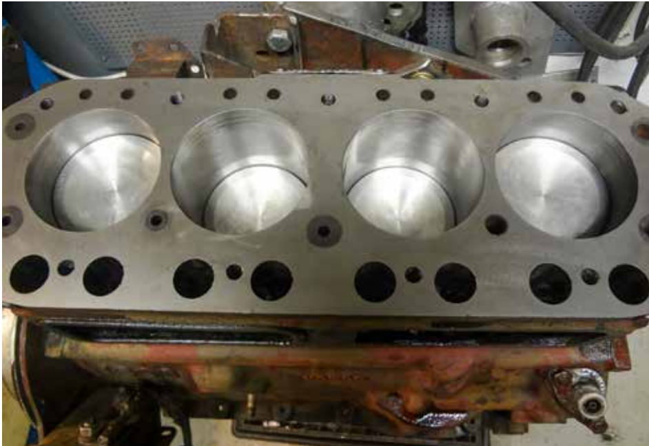
Motorn under sammansättning.
