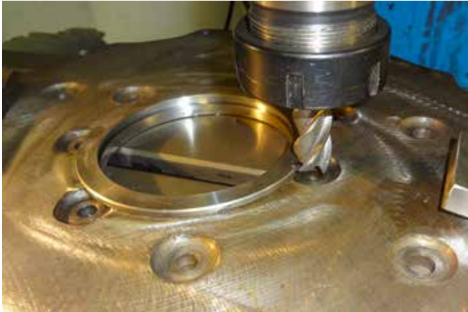
Urfräsning för bulthål.
