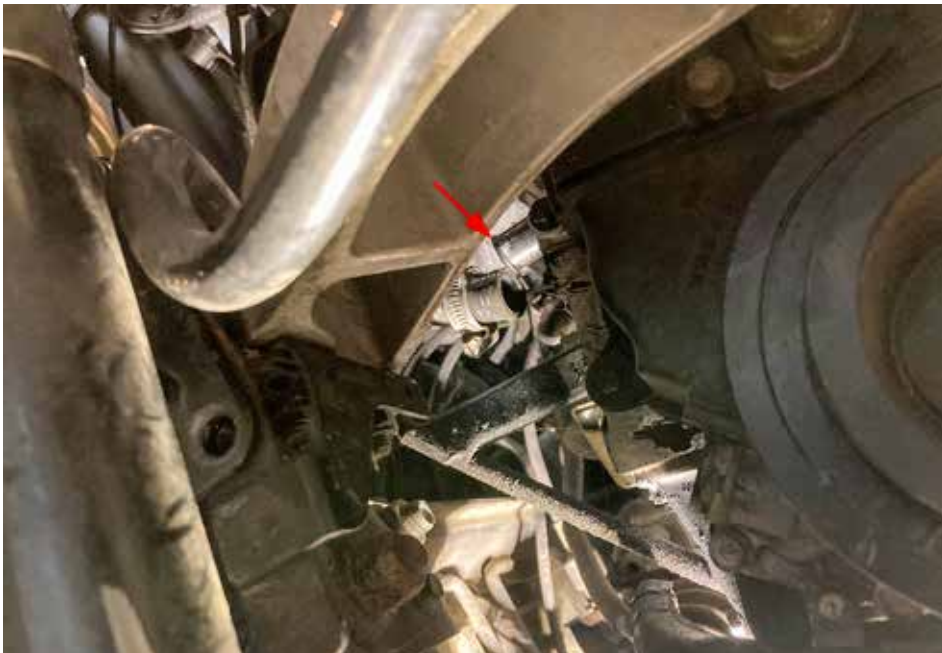
Bild 4, lossa slangen på motorns baksida.
