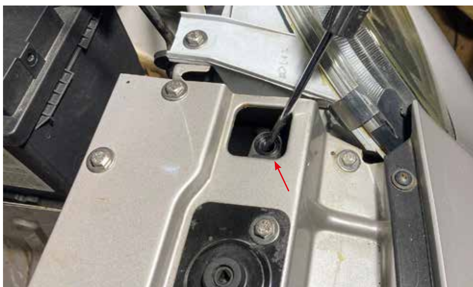
Bild 2, luftningsskruven på kylaren.
