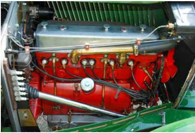
Den 1271 cc stora sexcylindriga motorn från höger
