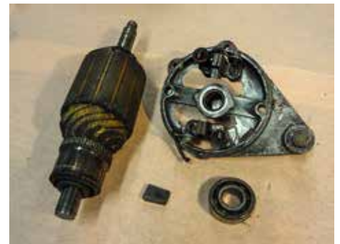
Generators skadade och utslitna delar.
