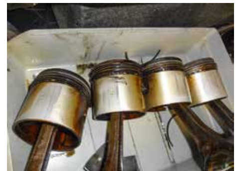
Trasiga övre kolringar, fastsittande skrapringar och skadade oljeringar samt tydliga skador på kolvarna. Vev och ramlager med repor. Det fanns även repor och korrosionsskador i oljepumpen.
