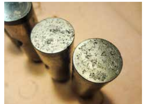
När man ser ventillyftarnas yta så förundras man över att det fanns tillräckligt material kvar på kamnockar så omslipning kunde utföras!
