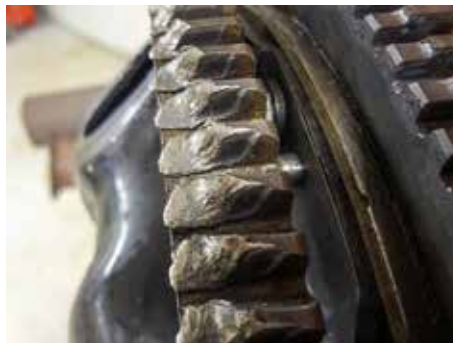
Att startkranen var skadad syns tydligt.
