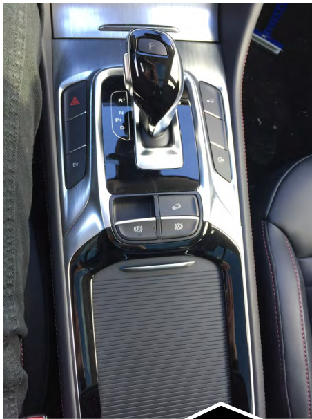
Automatgearet med 10-trins gearkasse er nemt at betjene. På siderne findes knapper til åbning af bagklap, EV kørsel (ren el), P-bremse m.v.
