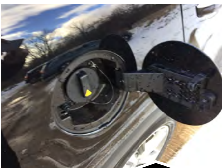
Dækslet for el-opladning sidder på højre side bagtil, og er nemt at komme til. En fuld opladning tager 5-6 timer.
