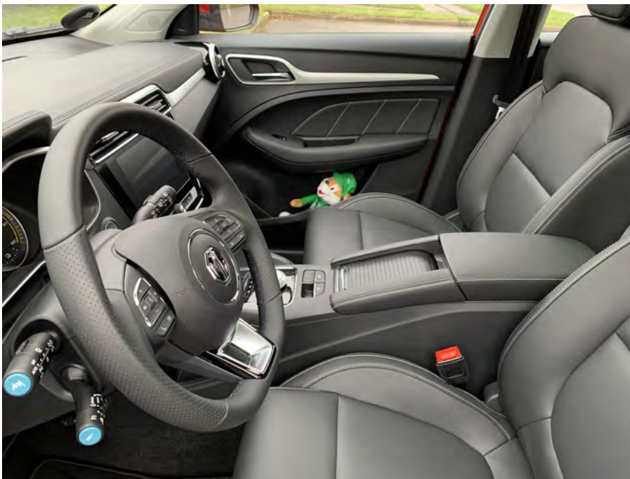
Der er ingen dørlåse eller tændingslås, så 'nøglen' skal bare ligge i lommen. Døren låser så op ved et tryk.
