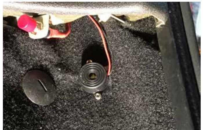
Summern fäste jag med två korta plåtskruvar i klädseln bakom förarstolen. Den röda knappen är till den elektriska bakluckeöppnaren.
