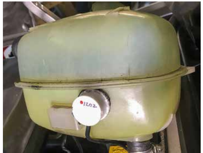
Sensorn limmad på framsidan av expansionskärlet.
