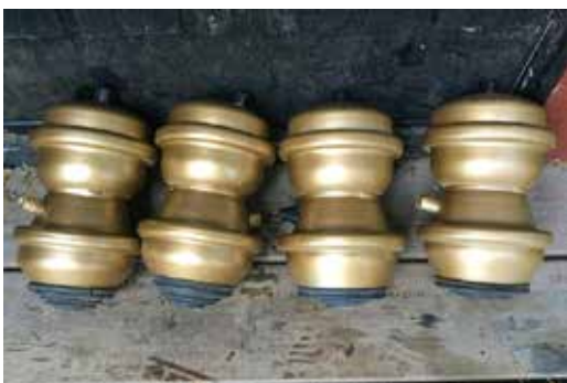
Nypåfyllda och nylackade Hydragas-donen i väntan på att bli återmonterade.
