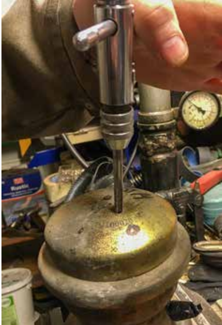
Hålet gängas, metallspån och nålar inuti klockorna tas bort med en liten magnet och tryckluft.
