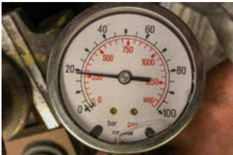
Cirka 18 bar med nitrogen fylls på.
