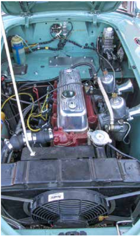
Pedantiskt rent motorrum. Flemming har bytt den gamla Wolseley-motorn till en femlagrad MGB-motor uppborrad till 1820 cc.
