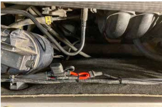
Kablarna kopplade jag ihop vid motorrummets bakre vägg. I stället för att använda de medföljande kabelskorna valde jag att löda ihop kablarna och isolera med krympslang. Detta är ju rakt under ventilationsöppningen i bakluckan. En säkring medföljde också.
