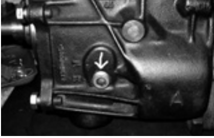
Links: Die (für die 5-Gang-Version) eigentlich zu tief sitzende Einfüllschraube; rechts die Lösung von Dietmar Pauw mit der Öffnung im Getriebedeckel (Pfeil)
