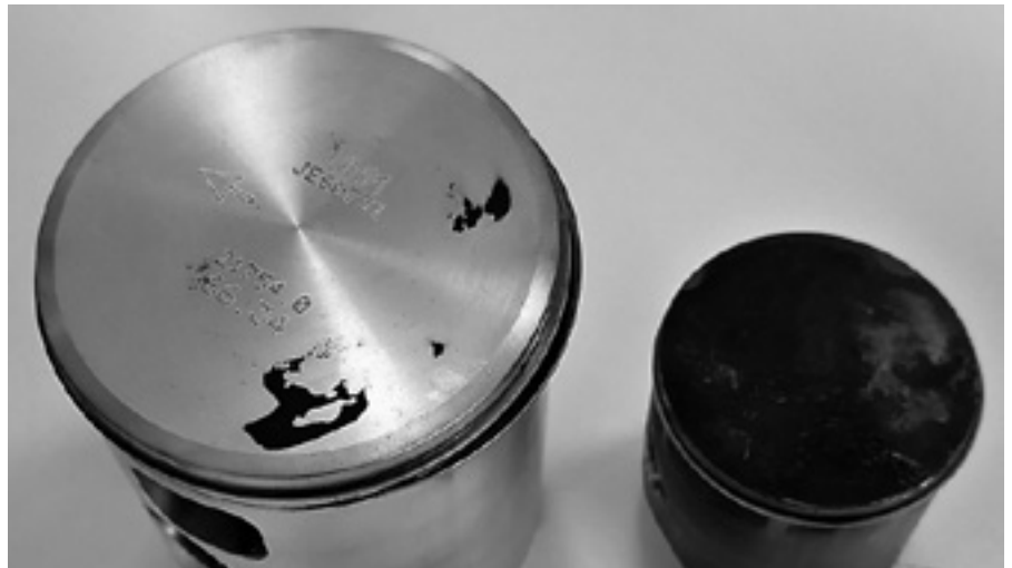
So sieht es aus: Kolbenboden, links mit Alkylat, rechts mit herkömmlichem Benzin gefahren - der Unterschied ist signifikant
