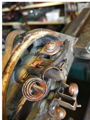
2. Man kan her se kullederen. Kuller sidder så det ikke kan komme helt ned i holderne.
