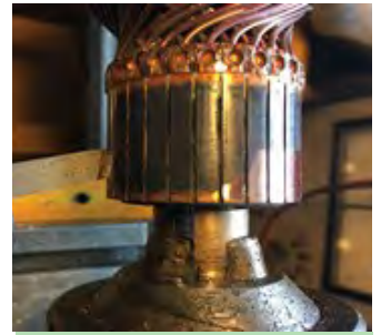
9. Så skal vi have drejet ankeret af. Det er meget vigtigt ved udskiftning af kul. Her et næsten nyt anker der var skævt fra fabrikken.
