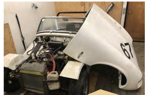
Donorbilen. Vi demonterede frontklappen. Den skal ikke bruges, og bilen blev så tilpas kort, at begge biler kunne stå i forlængelse af hinanden.
