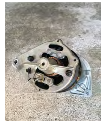
15. Man kan afprøve dynamoen ved at forbinde, den tykke og den tynde pol sammen, med et stykke ledning (uden de originale ledninger !!) Ved ca. 1500 omdr. skal der komme en kraftig gnist, når man "knistre" med en skrue trækker til stel.
