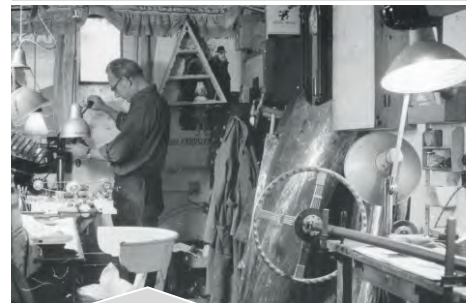
Delene repareres i værkstedet, forskærmen er afsyret, ratstammen og snekkedrev justeret
