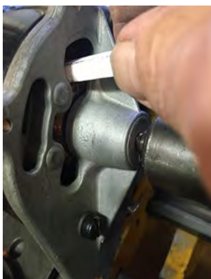
13. Når dynamoen er samlet og kører, holder man et stykke sandsten på kommutatoren, så kullene bliver slides til og støjfri
