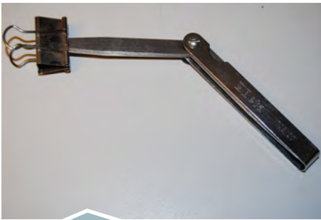
Fig. 3a: I stedet for at anvende en rund genstand for at måle svømmerhøjden på en HS karburator, kan man anvende søger-blade. Saml så mange søgerblade så du har en 'stak' på f.eks. 4 mm og hold dem sammen med en klemme. Det er en nemmere og mere præcis metode til at måle svømmerhøjden end den forekrevne.
