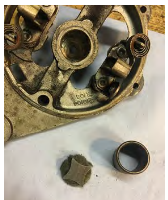
6. Man skal passe på denne filtskive og metalskive, som sidder for at holde på olien.
