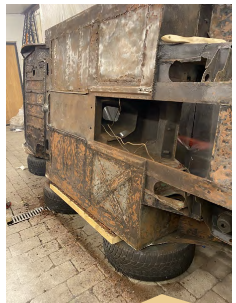
Bilen blev vippet op på siden på 3 dæk. Så var det let at komme til undervognen
