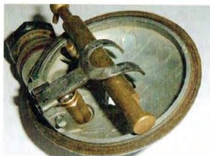
Fig. 2: Justering af svømmerhøjde på SU type H. Målelæren er 7/16' eller ca. 11 mm.
