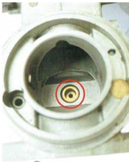
Fig. 6: Sænket hovedstrålerør med afstandsstykke (gaffelnøgle) monteret.
