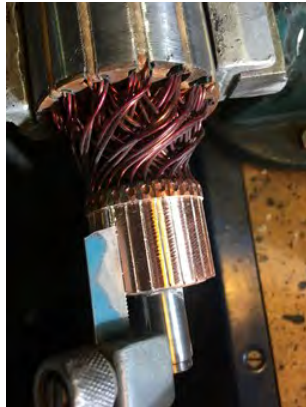
10. Når ankeret er drejet af, skal kommutatorens rillerne „stikkes” op med en gammel nedstrygerklinge
