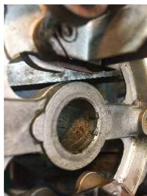
5. Her ser man, at der har været brugt en skruetrækker, for at få bøsningen ud - ødelagt dæksel.
