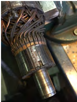
1. Her ser man et ødelagt anker, fordi man ikke har drejet ankeret af, inden man har sat nye kul i
