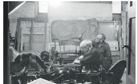
Bilen bygges op i vaskekælderen - chassis rammen er rensat og malet. Bagtøj og styretøj eftersat og monteret, nye fjedre
