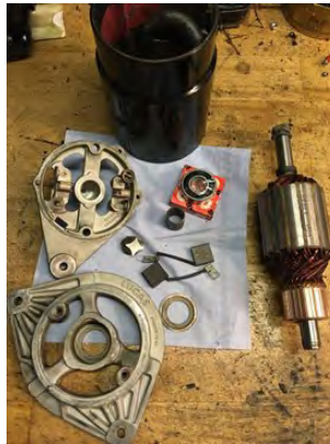
11. Så er vi klar til at samle, med nyt kugleleje, bøsning og kul
