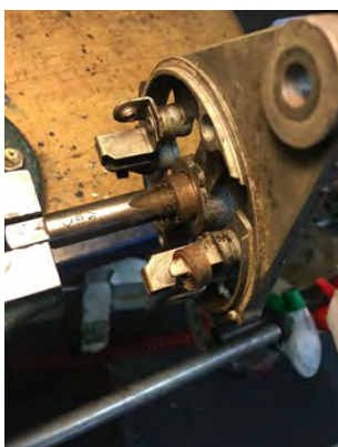
4. Når man tager bøsningen ud, kan man bruge en snit-tap/gevindskærer. Så kan man nemt dreje den ud
