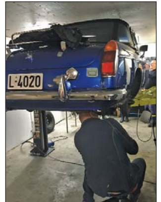
Kjetil Arnøy tapper ut bremsevæske på Odd Smith sin MGB.
