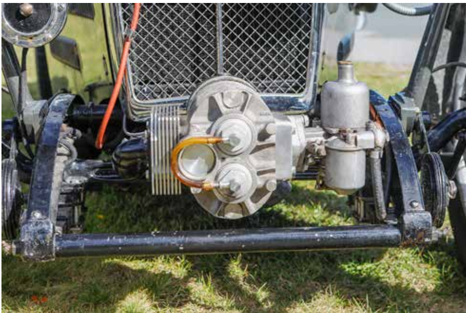
Kompressorn är moterad direkt i motorn.
