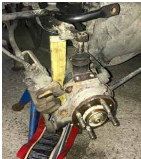
Allt är lossat och övre bärrarmen upphissad med tråkloss för att nå över spindelleden.
