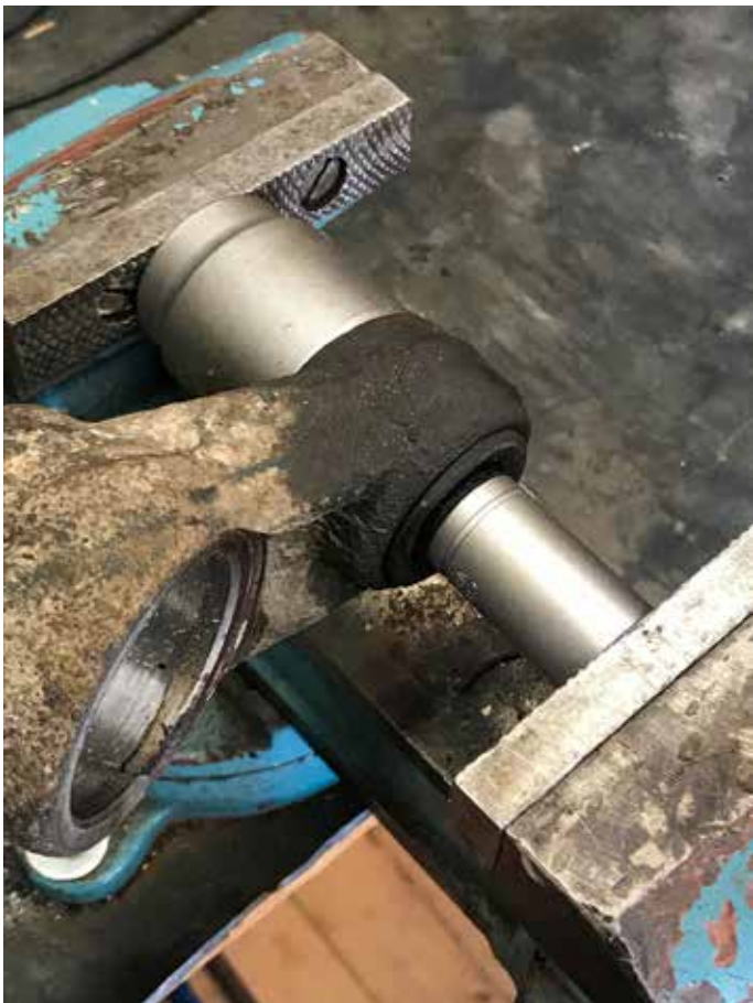
Urpressning av bussning i bärmarm med hjälp av hylsor i ett skruvstöd.
