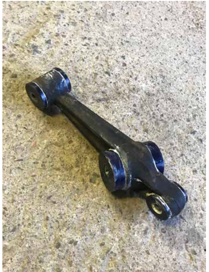
Undre bärmarm med nya bussningar monterade.
