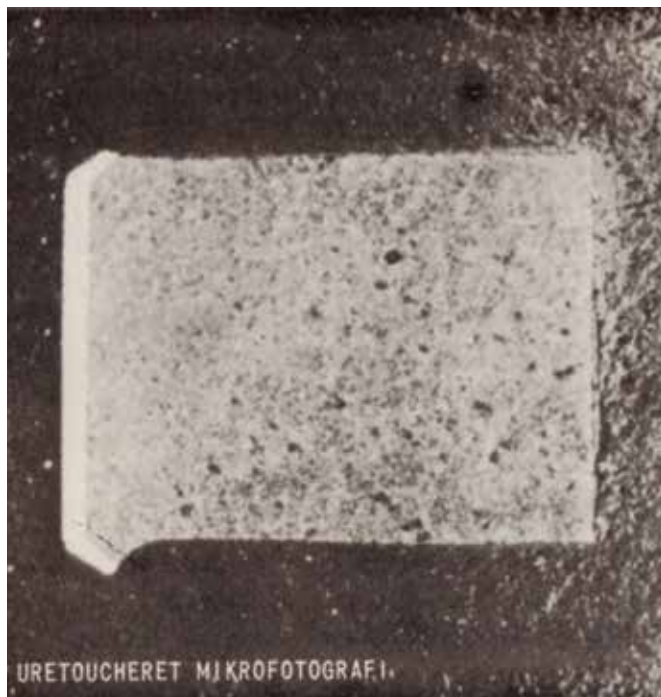
Denne forkromede kompressionsring er meget slidt på siderne efter 6.500 km's kørsel. Bemærk fremspringene foroven og forneden ved ringens berøringsflade.
