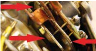
Nærbillede af dioderne på en 'bambus' generator. Ikke meget køling, men store loddeklatter!
