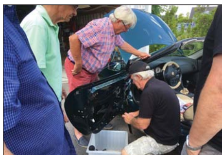
Gisle viser vindusjustering på MGF.
