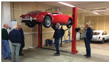
Tosoyler løftebukk ferdig montert og testet.
