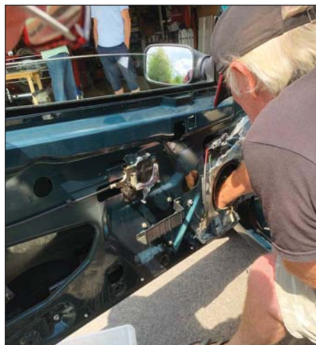
Gisle viste justering av vindu.
