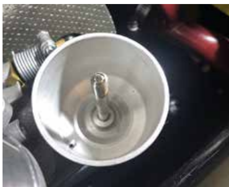
Flottörhus fritt från Loctite.
