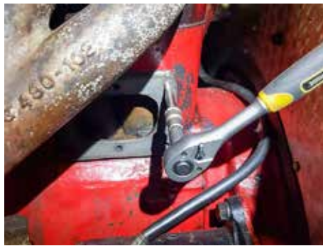
Reparation av trasig gänga i motorblocket.
