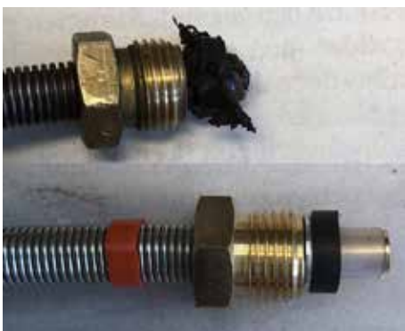
Det gamla plaströret och det nya.
