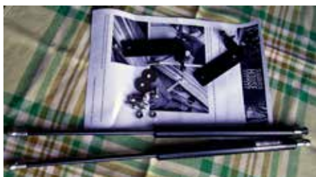
Detta är vad som var i paketet: två gasfjädrar, två konsoler, en bra bruksanvisning, alla nödvändiga skruvar och ett klistermärke.
