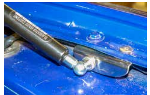
Ett nytt främre fäste bockades till och monterades i skärmkanten. Ett nytt hål fick borras.
