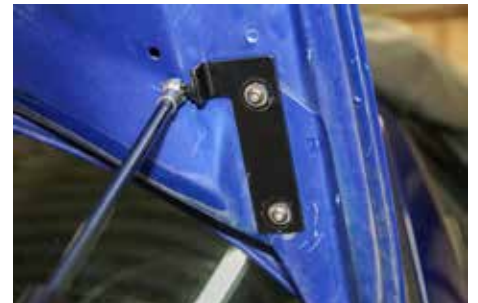
Vänster konsol vändes så att vi fick in gasfjädrern innanför skärmens fals.
