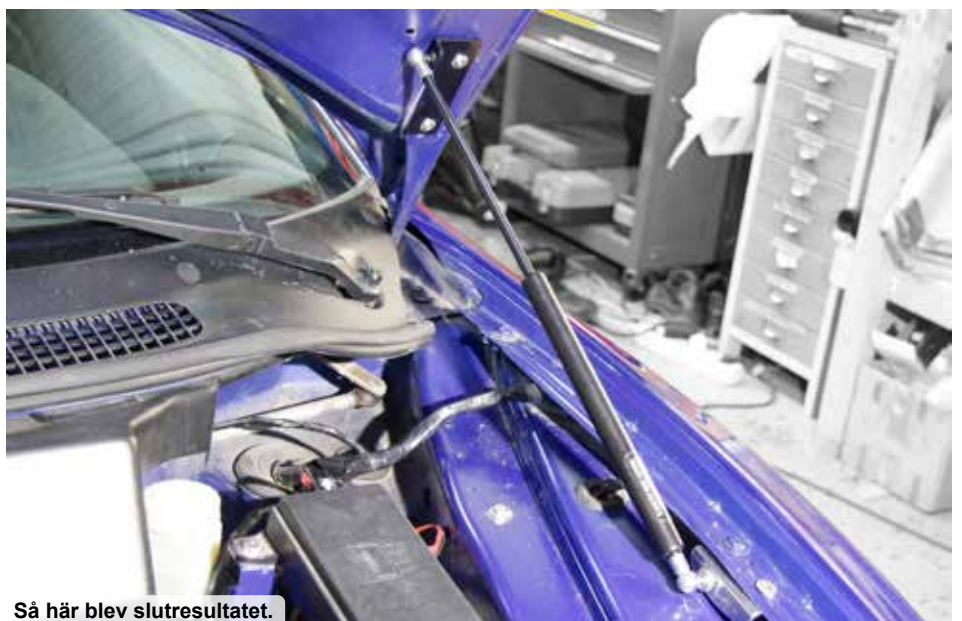
Ett nytt främre fäste bockades till och monterades i skärmkanten. Ett nytt hål fick borras.
