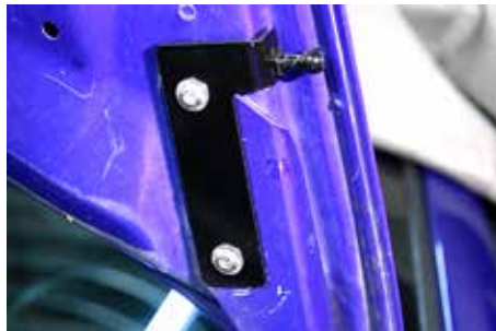
Vänster konsol vändes så att vi fick in gasfjädrern innanför skärmens fals.
