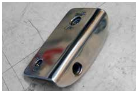
Ett nytt främre fäste bockades till och monterades i skärmkanten. Ett nytt hål fick borras.
