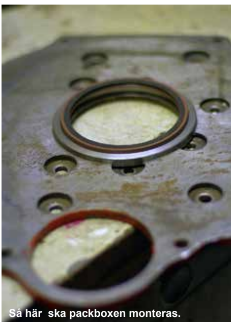
Packningen mellan motor och växellåda.
