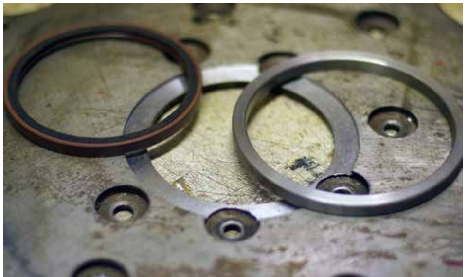
Delarna till packboxen på motorns bakre gavel. Spår har frästs för metallringen.
