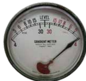
Tapley Gradient Meter – lutningsmätare.
