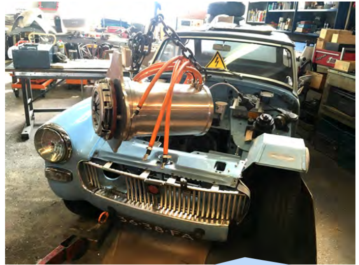
Motor er klar til at blive passet ind med koblingen
