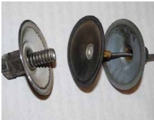
Destruktiv adskillelse af vakuumregulatoren.
