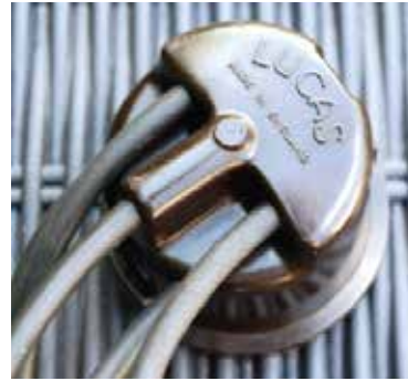
Originalt Lucas fordelerdæksel med 'side entry'.
