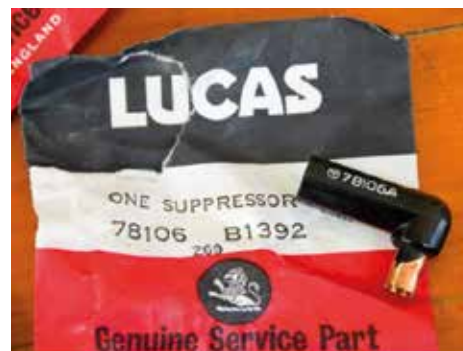
Originale Lucas tændrørshætter med indbygget modstand. (Suppressor). (MGAguru)
