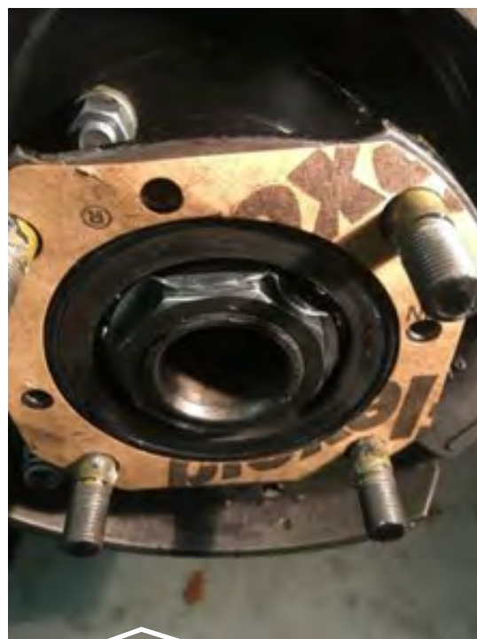
Spæn 19nm. Husk ny o.ring og pakning. (vigtigt da man ellers kan ødelægge lejet ) Pakningen er en slags shims / afstandsskive .
