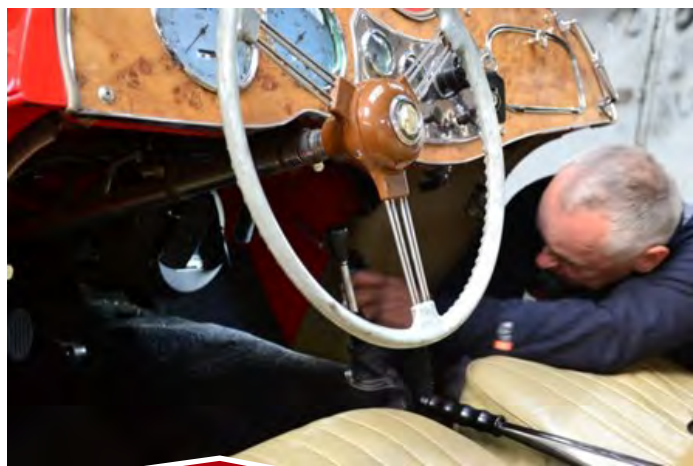
Vi fandt hullet til gearolie på en TD. Det er langt ind!
