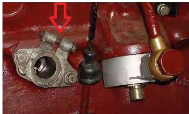
Strømfordeleren er afmonteret. Pilen peger på spændklampens bolt, der skal løsnes.
