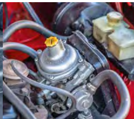
EN ENKELT ZENITH-KARBURATOR i stedet for Europa-versionens to SU'ere har en stor del af æren for det betragtelige krafttab
