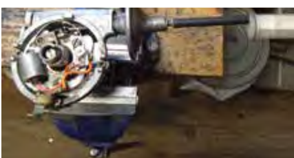
Test af strømfordelerens vacuumregulator
