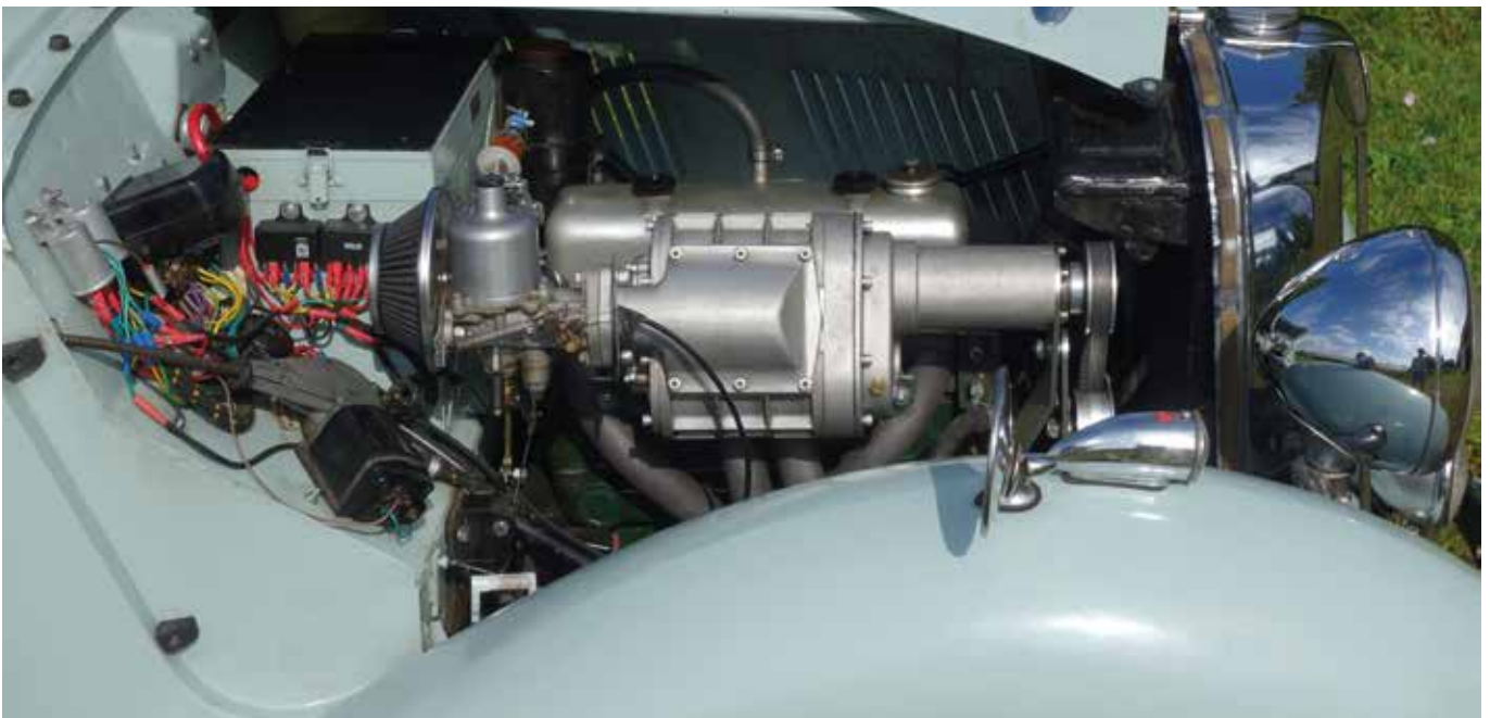
MGY motorrum med kompressor. Vognen er FIVA registreret med denne.
