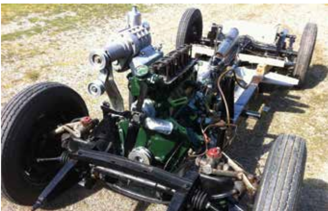
MGY chassis med motor. Det uafhængige forhjulsophæng med tandstangsstyring
