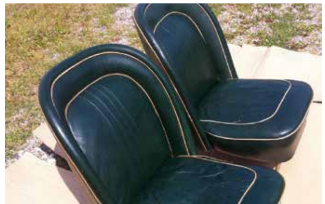
Interiør renoveret med brug af det originale materiale. Grønt læder.
