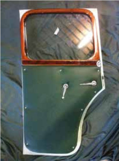
Dør monteres med betræk og maghoni ramme om vindue
